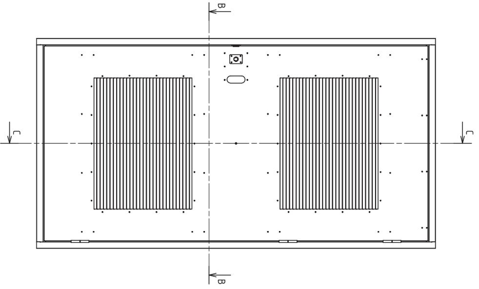
Côte de réservation béton = PU+80 = 1155
